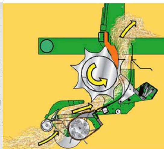
Рис. 7. Приклад реалізації евольвентного ножа та протирізальної пластини
