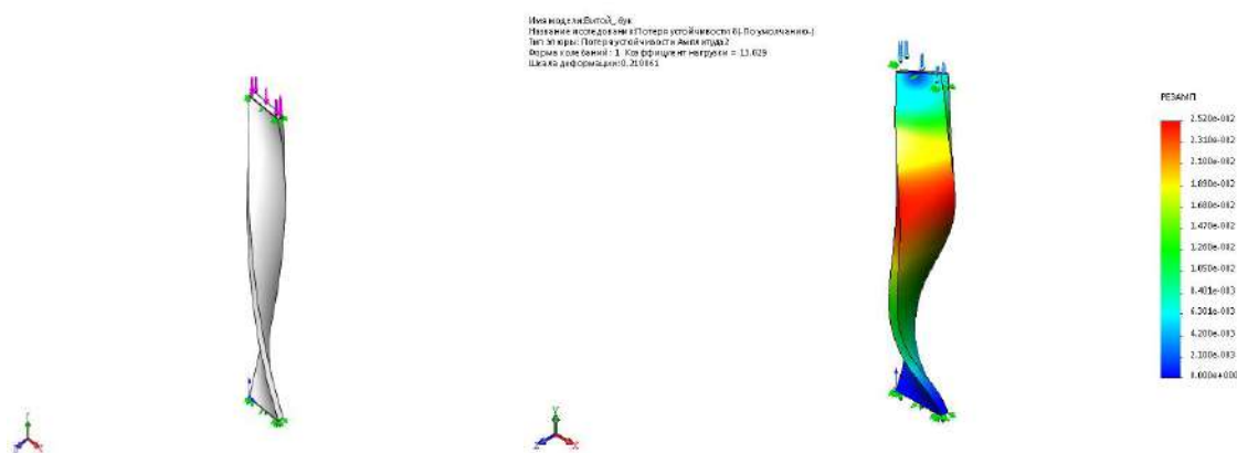
Рис. 3. Условия нагружения витого стержня (слева) и результаты исследования его на устойчивость (справа)
