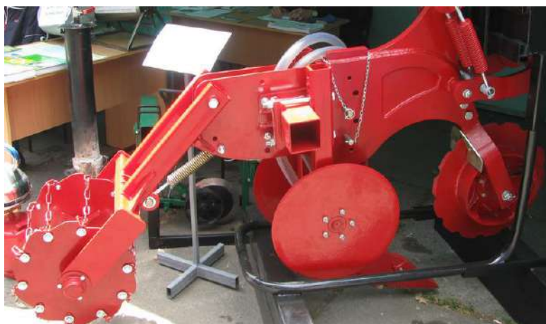
Рис. 4. Секція ґрунтообробного знаряддя для смугової обробки ґрунту
