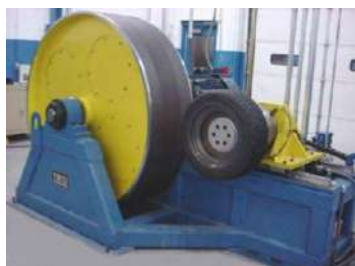
Рис. 2. Загальний вигляд станду з біговими барабанами, призначеного для проведення лабораторних досліджень процесу кочення колеса
