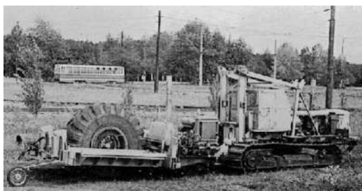
Рис. 1. Загальний вигляд станда для випробування колеса з пневматичною шиною
