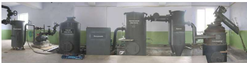
Рис. 3. Газогенераторна установка тепловою потужністю 300 кВт, що працює на рослинних залишках аграрного виробництва вологістю до 40 % (розробка Ліонінського інституту енергетичних ресурсів, КНР)
