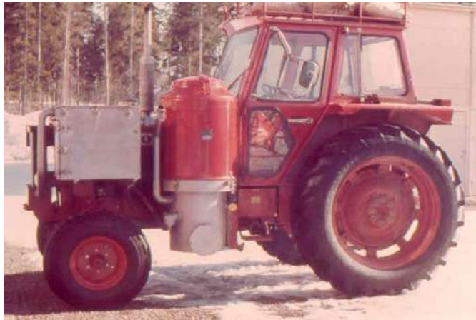
Рис. 1. Газогенераторний трактор фірми Volvo, який працює на пелетованих рослинних відходах
