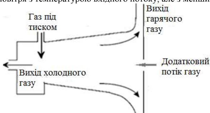
Рис. 6. Вихрова трубка з подачею додаткового повітряного потоку
