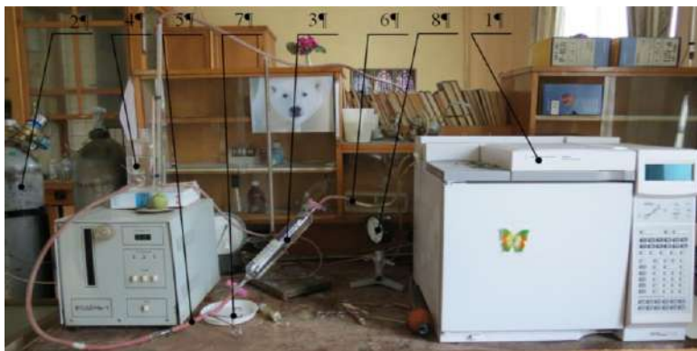
Рис. 1. Схема експериментальної установки для визначення складу генераторного газу: 1 – двоканальний хроматограф мод. Agilent 6890 N; 2 – балон з газом-носієм (аргоном); 3 – скляна піпетка на 500 мл з досліджуванним газом; 4 – смішувач з насиченим водним розчином повареної солі; 5 – гумовий рукав для підведення водного розчину; 6 – гумовий рукав для введення проби газу у випаровувач хроматографа; 7 – затискач; 8 – манометр.
