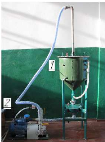
Рис. 1. Установка УВДБ-100Ф для дослідної перевірки енергетичної ефективності виробництва дизельного біопалива в циркуляційних змішувачах: 1 – циркулярний змішувач, 2 – гідростанція
