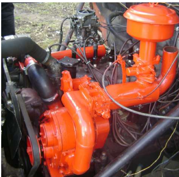
Рис. 2. Загальний вигляд нагнітача (з механічним приводом) газоповітряної суміші в циліндри двигуна
