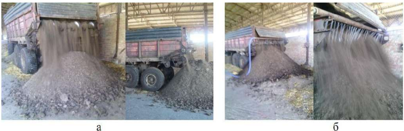
Рис. 2. Процес формування натурних буртів із використанням доопрацьованого розкидача органічних добрив ПРТ-10: а – без додаткового зволоження; б – із додатковим зволоженням
