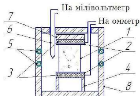
Рис. 3. Схема експериментальної установки [3]: 1 – зразок ЕКМ; 2 – прошарок ТРГ; 3 – графітові контакти; 4 – керамічний стакан; 5 – спіраль терморегулятора; 6 – терморегулятор; 7 – маса для притискування графітових контактів до зразка; 8 – стінки терморегулятора електричного
